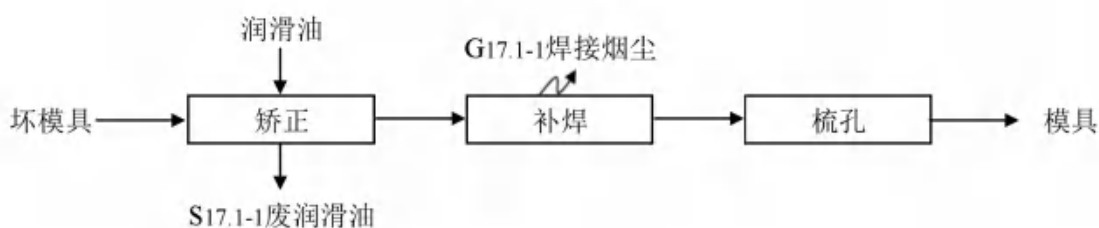
图3.5-17 模具修复工艺流程图
