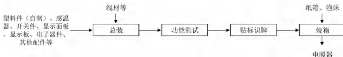
图3.5-14 电暖气总体生产工艺及产污流程图
