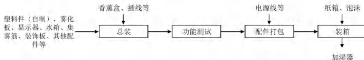
图3.5-13 加湿器总体生产工艺及产污流程图
